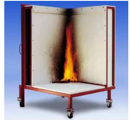
Single Burning Item Test apparatus for EN 13823
